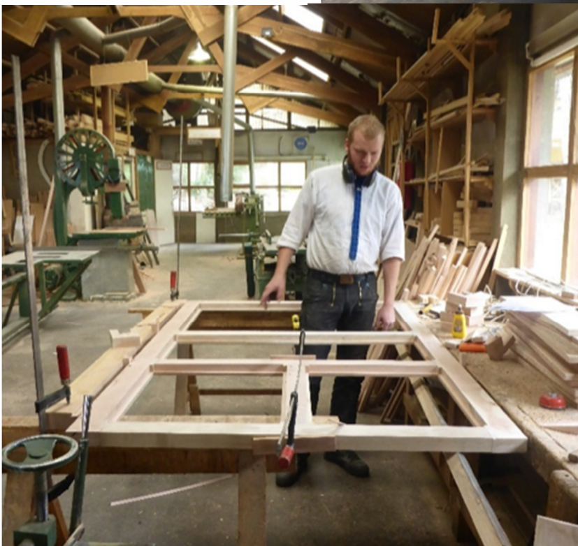
Verleimen mit minimalem Zwingeneinsatz
