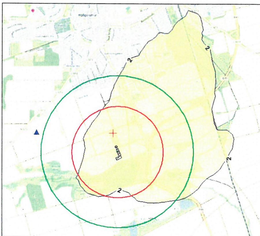
Abbildung 4.1: Ausdehnung ca. 600 m Radius (rot), ca. 1.000 m Radius (grün) und 2-Prozent-Isoplethe Plan-Zustand Höppl-Müller GbR
