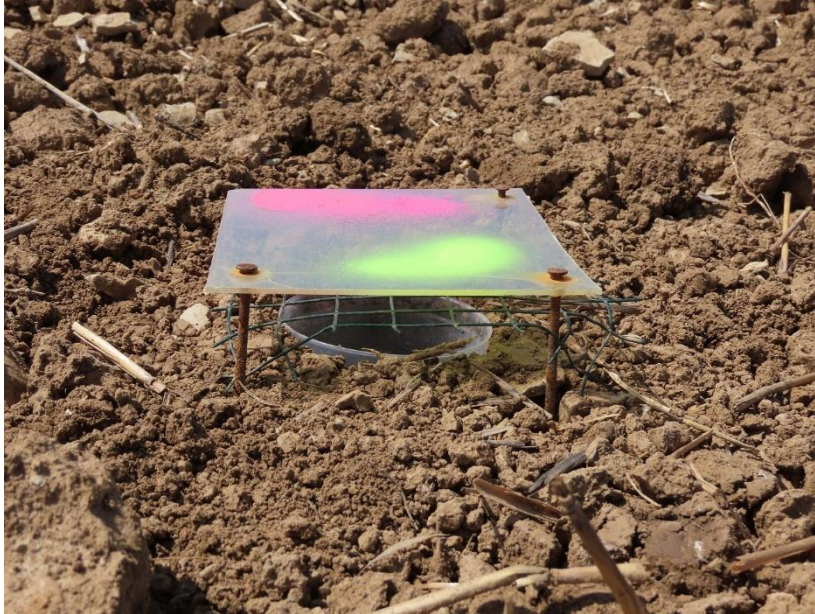
Abbildung 2 Bodenfalle nach BARBER (1931) mit Schutzgitter und Abdeckung.
