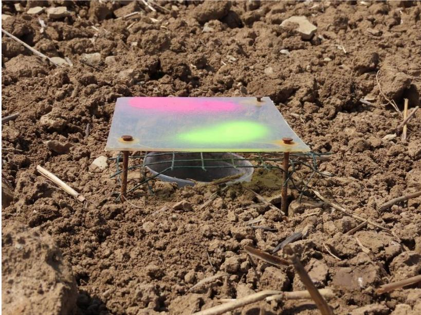
Abb. 2: Bodenfalle nach BARBER (1931) mit Schutzgitter und Abdeckung.
